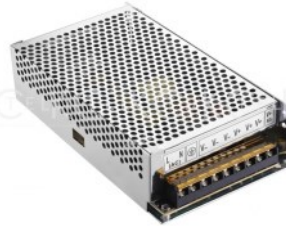
FUENTE PODER 72W WATTS-AMP: 72W-6Amp MEDIDA: 160X98X42 mm VOLTAJE SALIDA: 12V VOLTAJE: 90-130V IP: 20 TERMINADO: ALUMINIO
