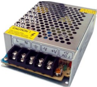
FUENTE PODER 40W WATTS-AMP: 40W-3.33Amp MEDIDA: 85X58X33 mm VOLTAJE SALIDA: 12V VOLTAJE: 90-264V IP: 20 TERMINADO: ALUMINIO
